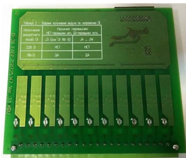
Рисунок 16 – Расположение и комбинации перемычек J4 . . . J14 для задания напряжений дискретных входов на 110 и 220 В
