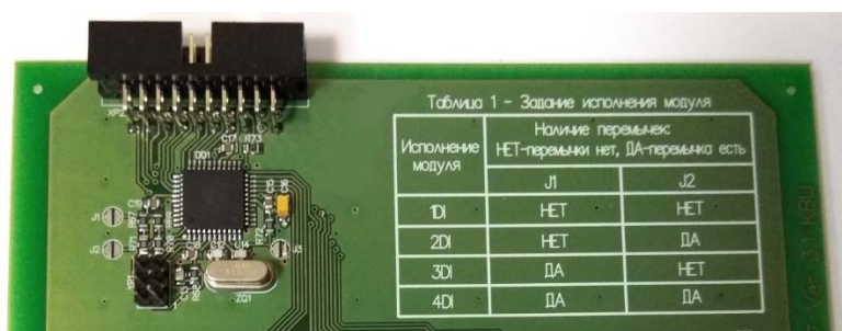
Рисунок 15 – Расположение и комбинации перемычек J1 и J2 для задания исполнений модуля DI
