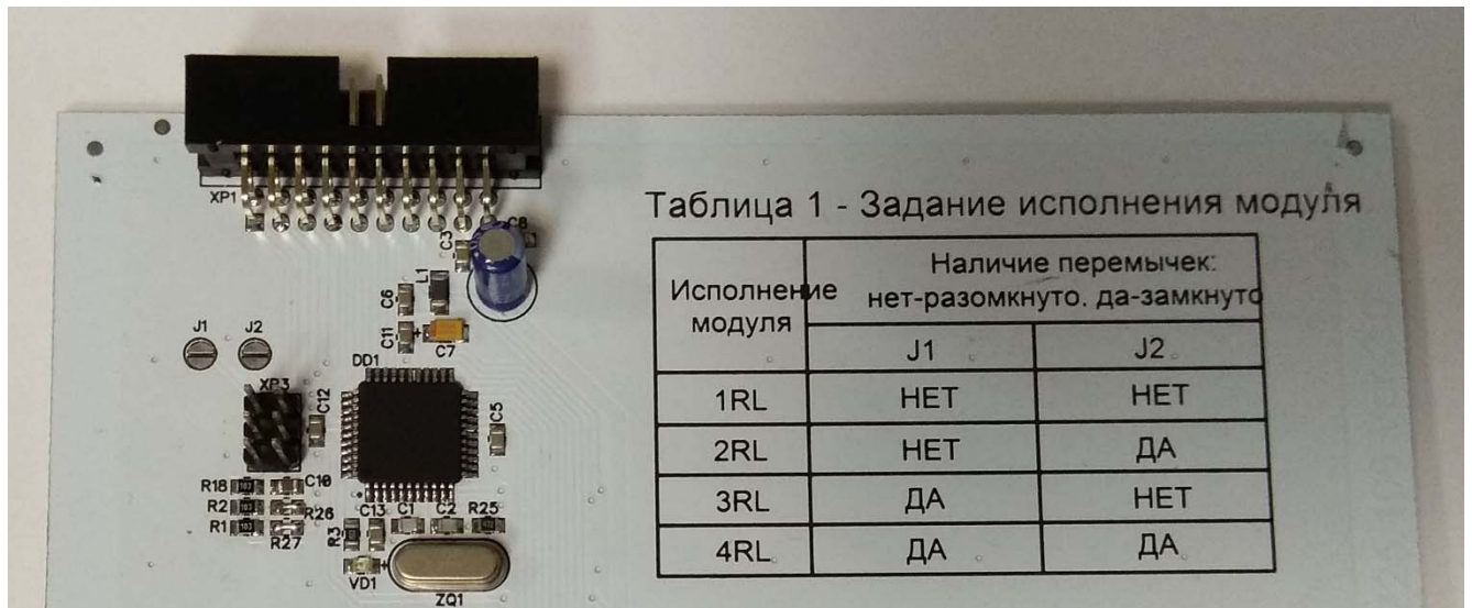
Рисунок 18 – Таблица задания исполнений модуля RL и места расположения перемычек J1 и J2
