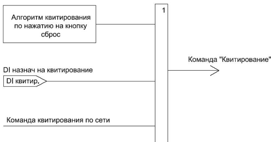
Рисунок 22 – Алгоритм работы функции квитирования
