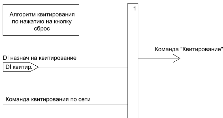
Рисунок 40 – Алгоритм работы функции квитирования
