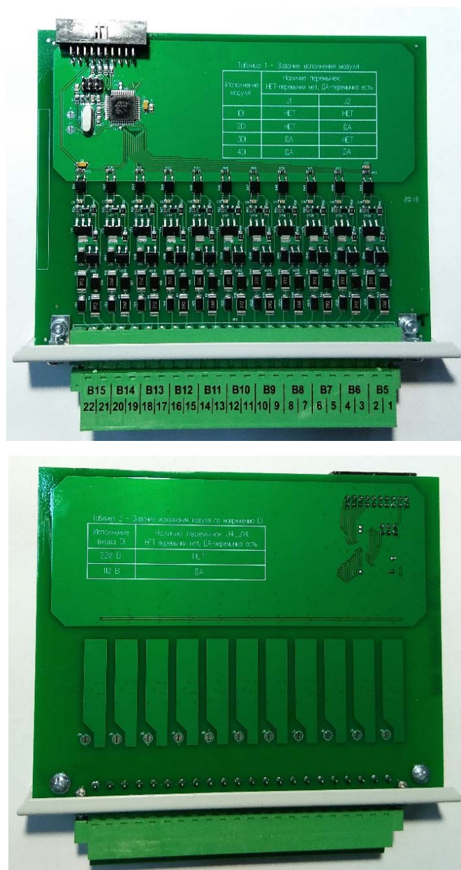
Рисунок 8 – Расположение и комбинации перемычек J1, J2, J4...J14 для задания напряжений дискретных входов на 220 и 110 В
