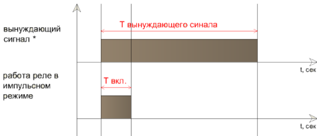
Рисунок 38 – Временная диаграмма работы реле KL1 - KL3 в импульсном режиме
