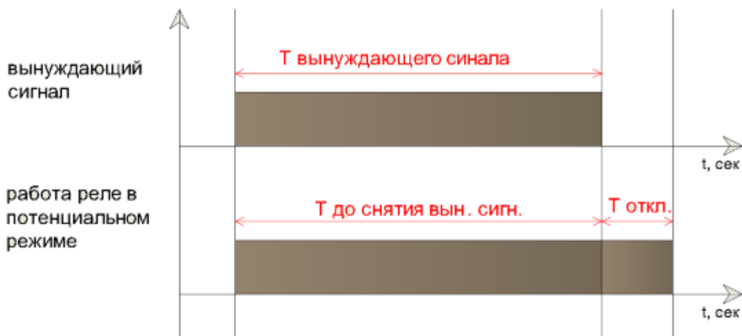
Рисунок 40 – Временная диаграмма работы реле KL1 - KL3 в потенциальном режиме
