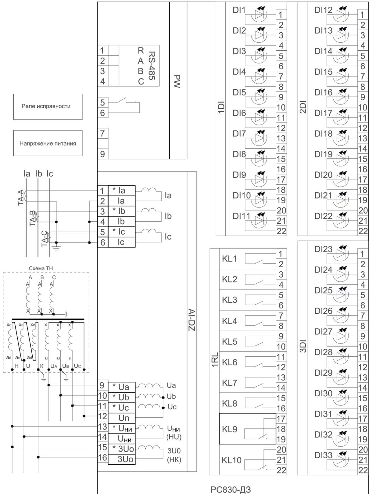
Рисунок Б.3 – Схема подключения устройства PC830-D3 (исполнений XX13XXXXXX)
