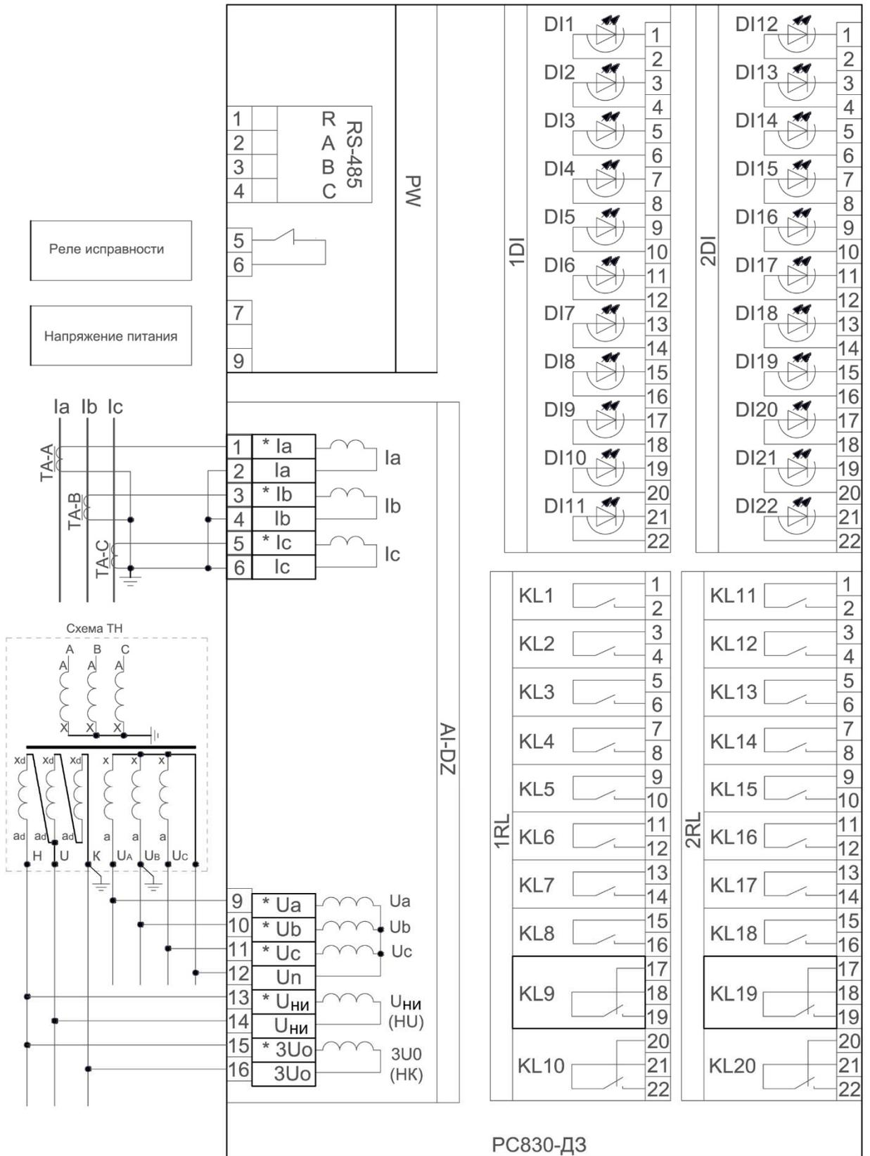
Рисунок Б.2 – Схема подключения устройства PC830-ДЗ (исполнений XX22XXXXXX)
