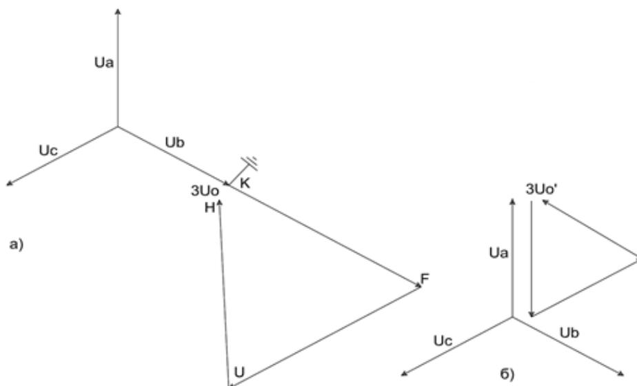
Рисунок 101 – а) векторная диаграмма напряжений на ТН; б) векторная диаграмма напряжений в алгоритме БНН
