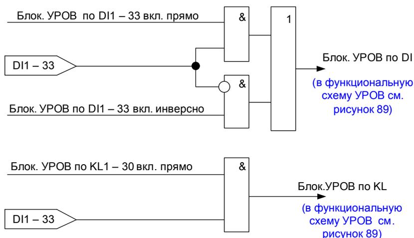
Рисунок 90 – Алгоритм формирования сигналов блокировки УРОВ по дискретным входам и логическим выходам реле
