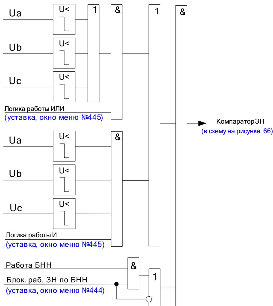
Рисунок 68 – Функциональная схема логики компаратора ЗН при работе в режиме ЗМН по фазным напряжениям
