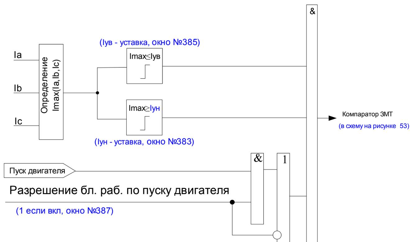
Рисунок 55 – Функциональная схема логики компаратора ЗМТ
