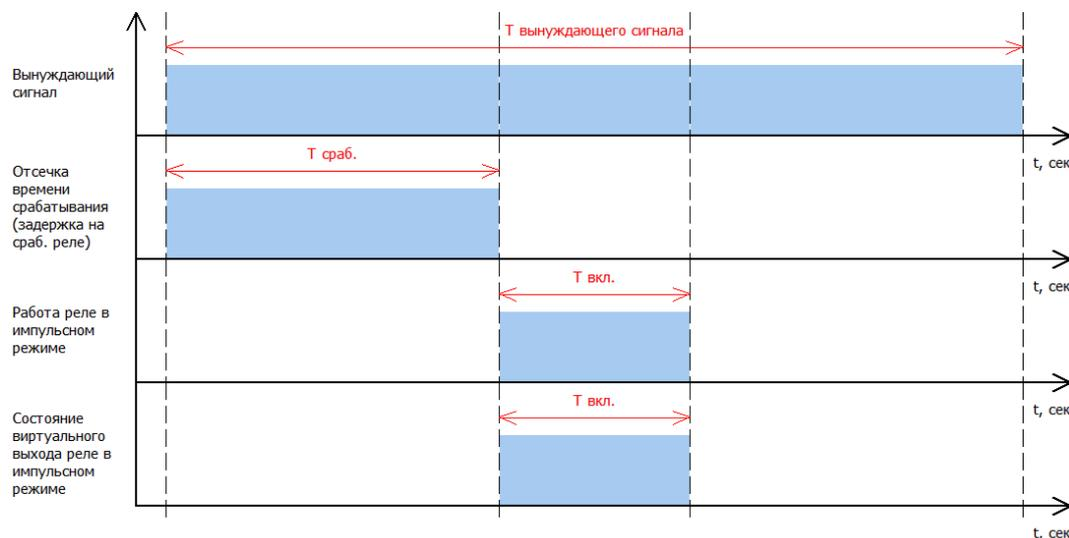
Рисунок 105 – Временная диаграмма работы реле в импульсном режиме
