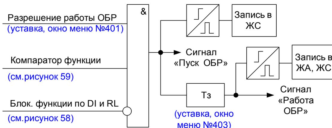
Рисунок 57 – Фрагмент функциональной схемы логики ОБР
