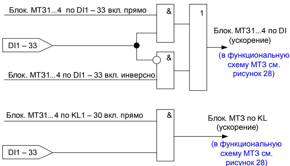
Рисунок 29 – Алгоритм формирования сигналов блокировки (ускорения) МТЗ по дискретным входам и логическим выходам реле
