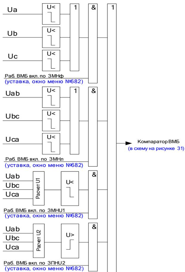
Рисунок 34 – Функциональная схема логики компаратора ВМБ
