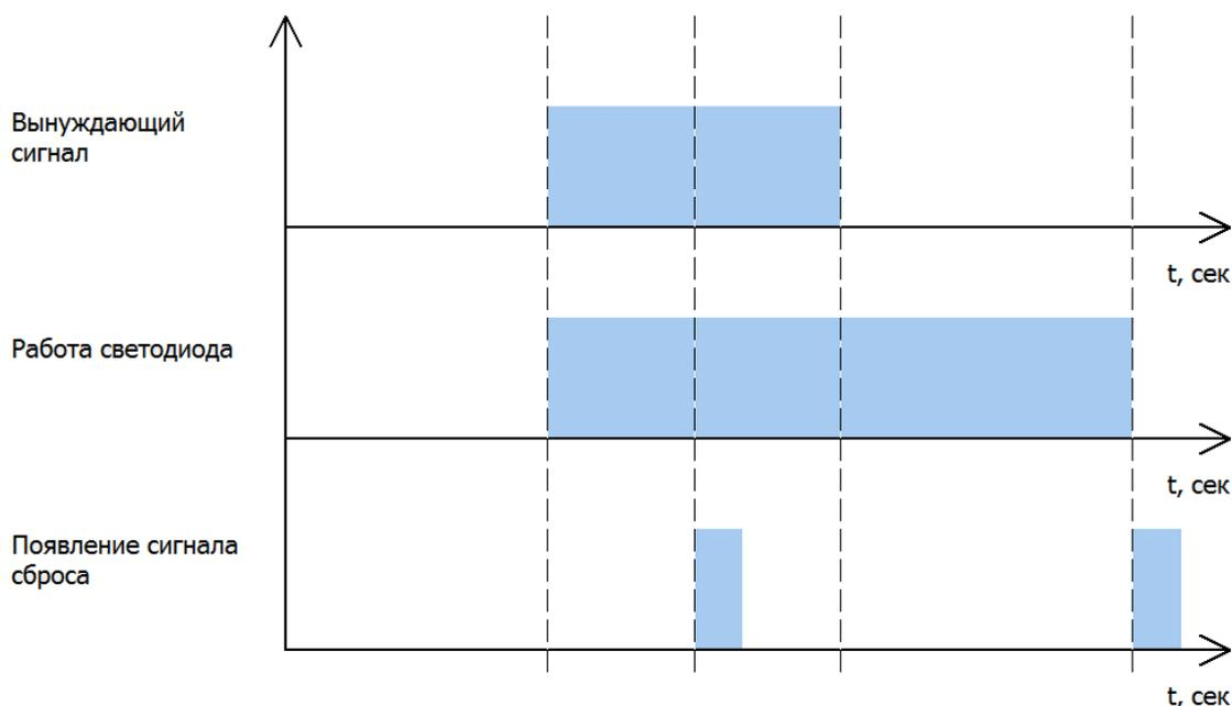
Рисунок 115 – Временная диаграмма работы светодиодов в режиме с фиксацией
