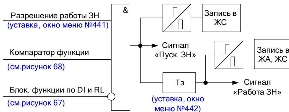
Рисунок 66 – Фрагмент функциональной схемы логики ЗН
