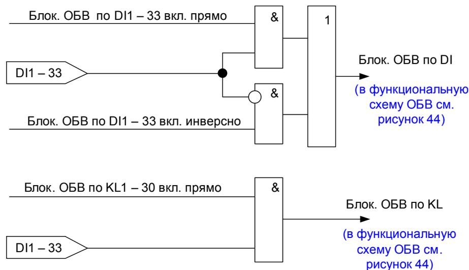
Рисунок 45 – Алгоритм формирования сигналов блокировки ЗВС по дискретным входам и логическим выходам реле
