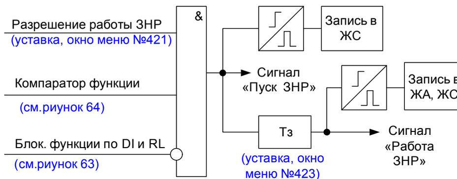
Рисунок 62 – Фрагмент функциональной схемы логики ЗНР
