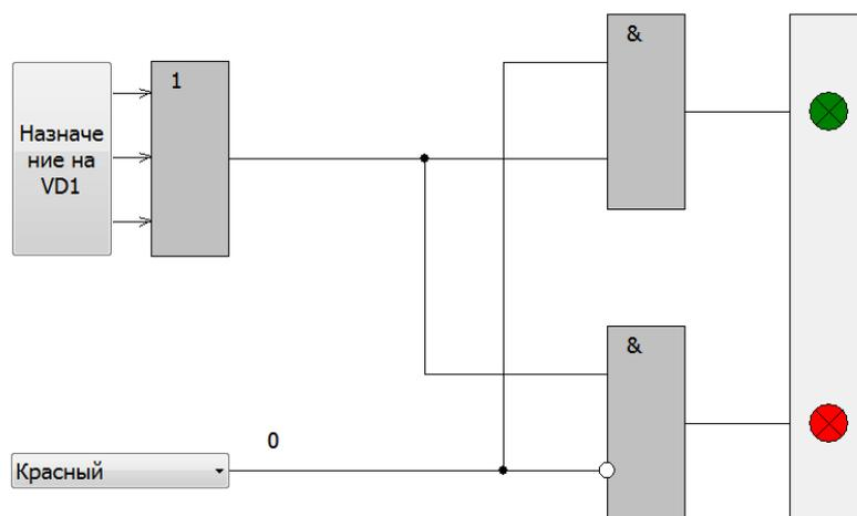
Рисунок 112 – Алгоритм работы светодиодов в потенциальном режиме
