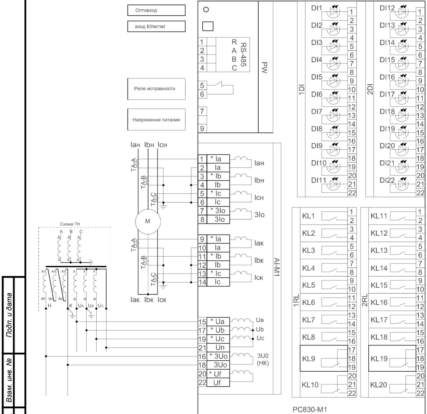
Рисунок Е.2 – Схема подключения устройства PC830-M1 (исполнений XX22XXXXXX)
