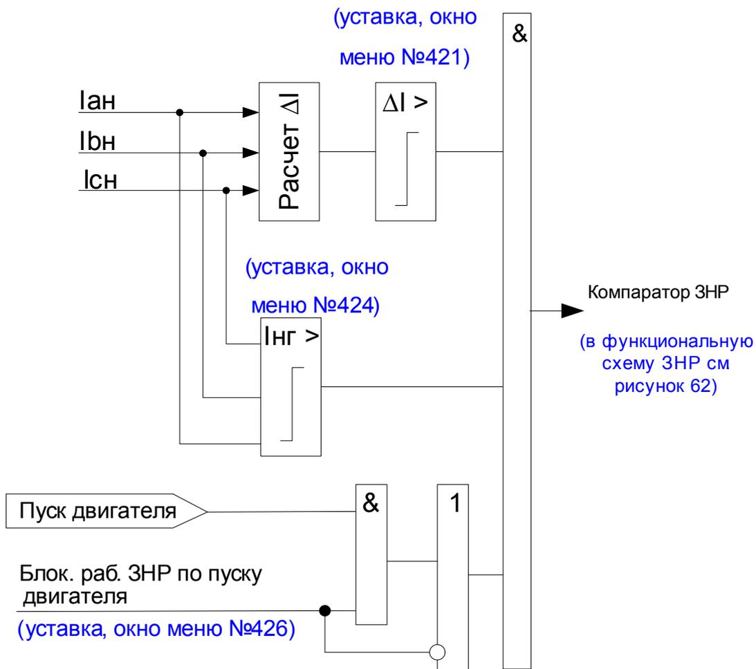
Рисунок 64 – Функциональная схема логики компаратора ЗНР
