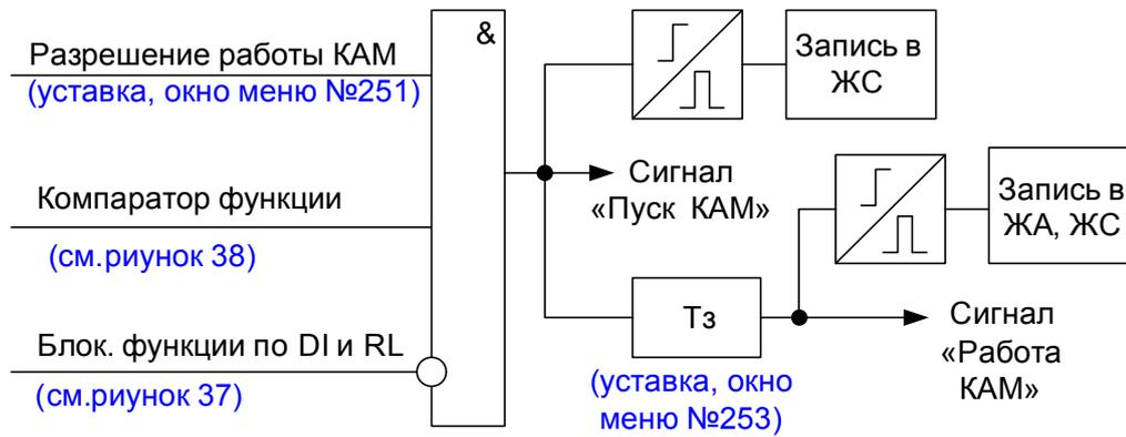
Рисунок 36 – Фрагмент функциональной схемы логики КАМ
