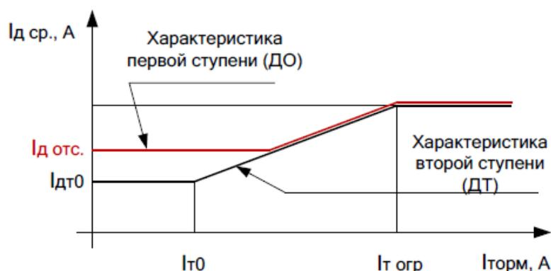
Рисунок 17 – Характеристика срабатывания ДО при уставке по току срабатывания ДО ниже тока срабатывания ДТ
