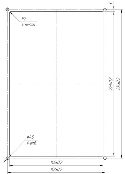
Рисунок Б.2 – Внутренний монтаж устройства РС830-М1
