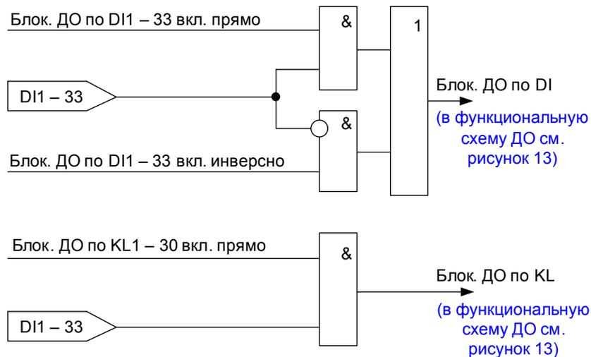
Рисунок 14 – Алгоритм формирования сигналов блокировки (ускорения) ДО по дискретным входам и логическим выходам реле
