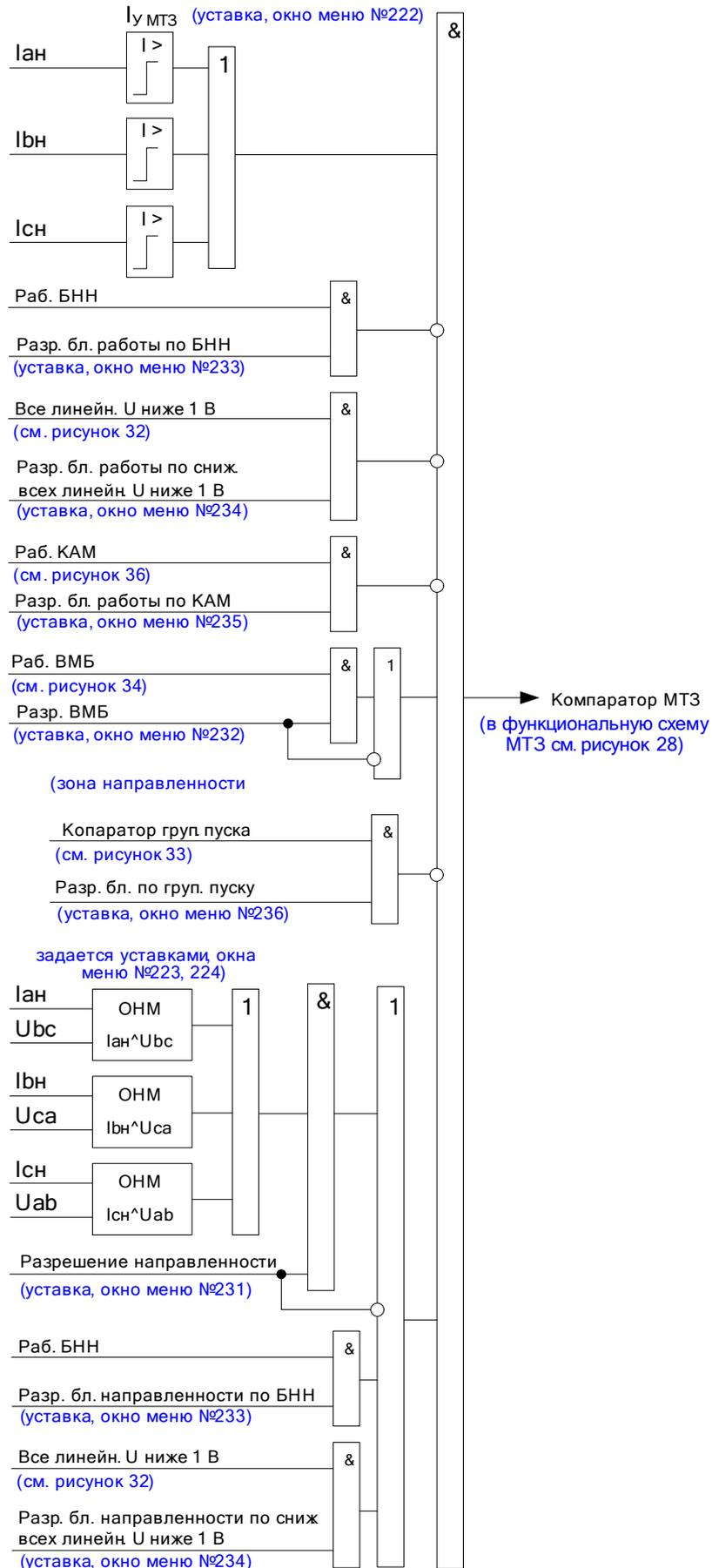
Рисунок 31 – Функциональная схема логики компаратора МТЗ
