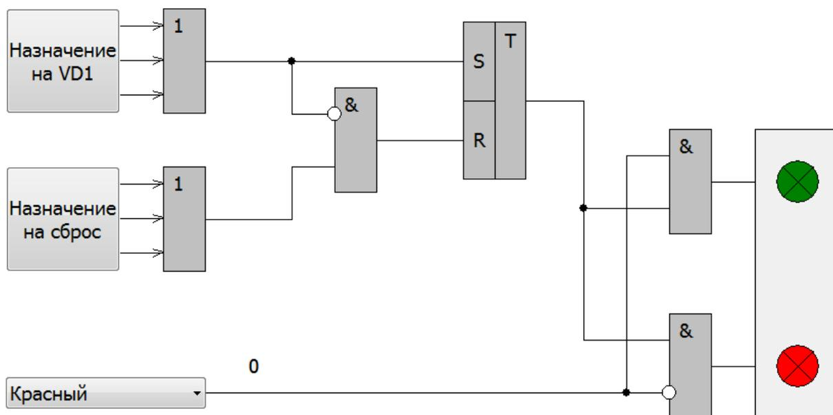
Рисунок 114 – Алгоритм работы светодиодов в режиме с фиксацией
