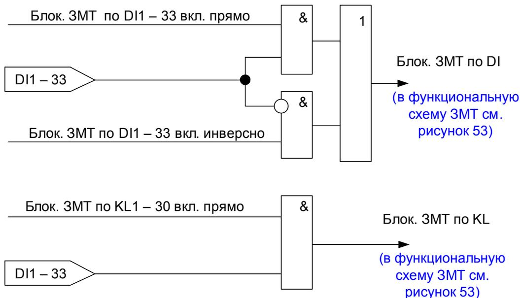
Рисунок 54 – Алгоритм формирования сигналов блокировки ЗМТ по дискретным входам и логическим выходам реле
