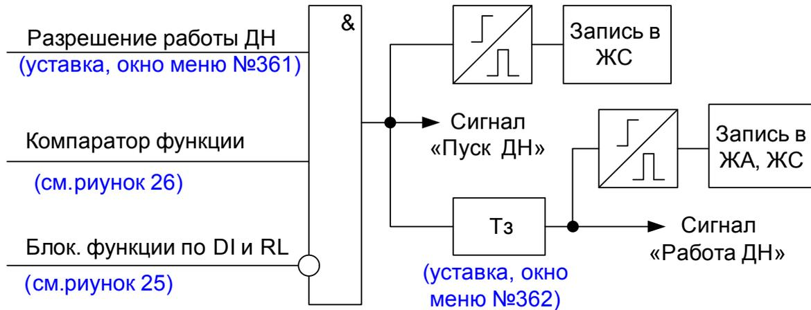
Рисунок 24 – Фрагмент функциональной схемы логики ДН
