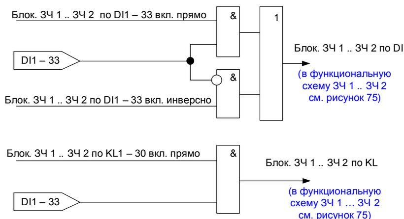
Рисунок 76 – Алгоритм формирования сигналов блокировки ЗЧ по дискретным входам и логическим выходам реле
