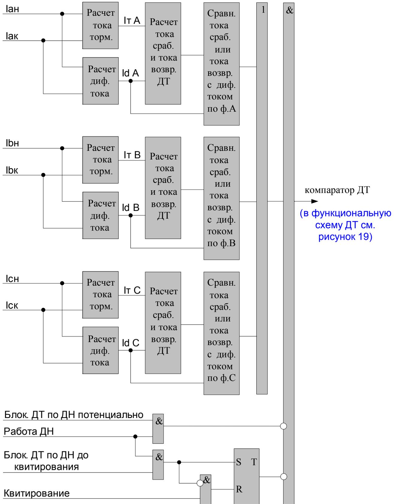
Рисунок 21 – Функциональная схема логики компаратора ДТ
