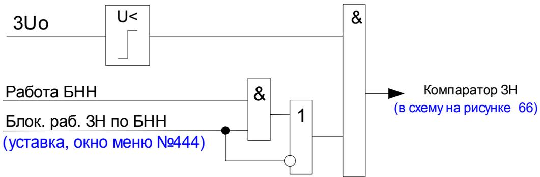
Рисунок 71 – Функциональная схема логики компаратора ЗН при работе в режиме ЗНЗ
