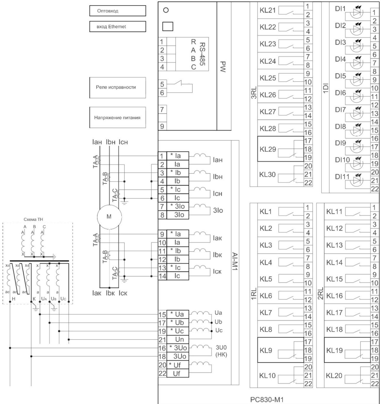
Рисунок Е.1 – Схема подключения устройства РС830-М1 (исполнений XX31XXXXXX)
