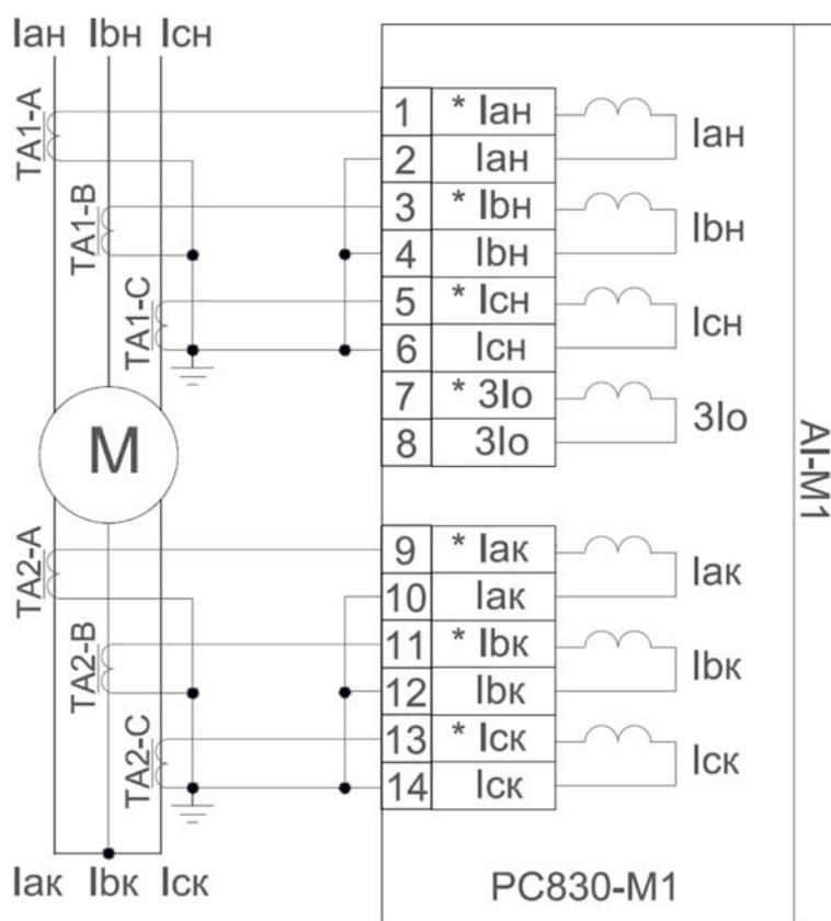
Рисунок 12 – Схема подключения токовых цепей двигателя
