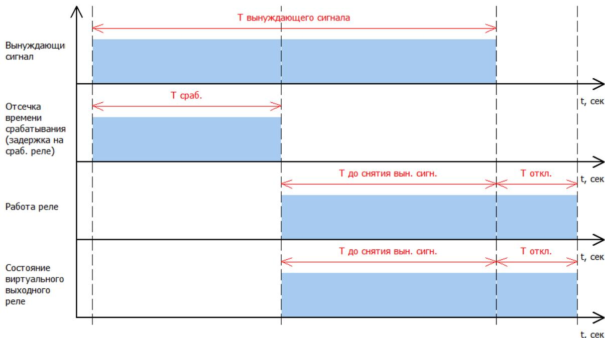
Рисунок 109 – Временная диаграмма работы реле в потенциальном режиме
