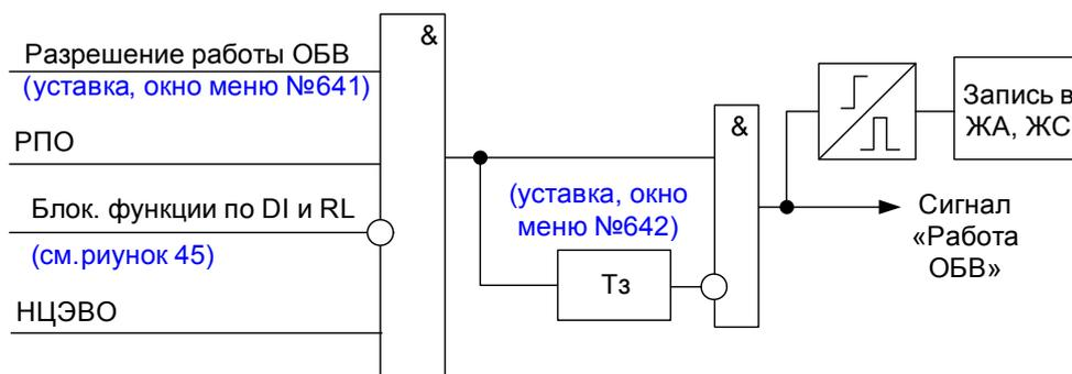
Рисунок 44 – Фрагмент функциональной схемы логики ОБВ
