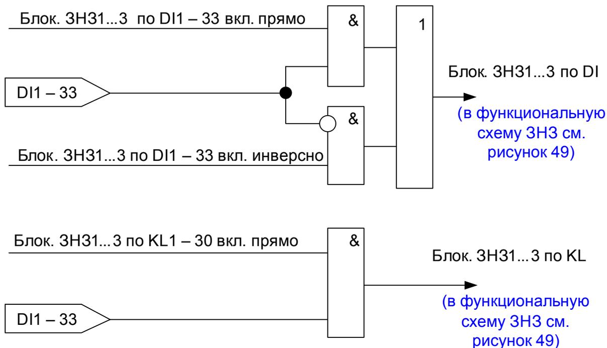
Рисунок 50 – Алгоритм формирования сигналов блокировки (ускорения) ЗНЗ по дискретным входам и логическим выходам реле
