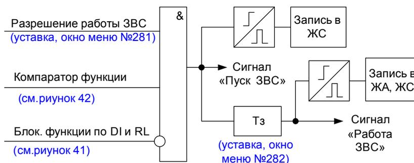
Рисунок 40 – Фрагмент функциональной схемы логики ЗВС
