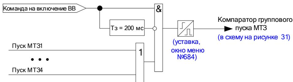
Рисунок 33 – Функциональная схема логики компаратора группового пуска
