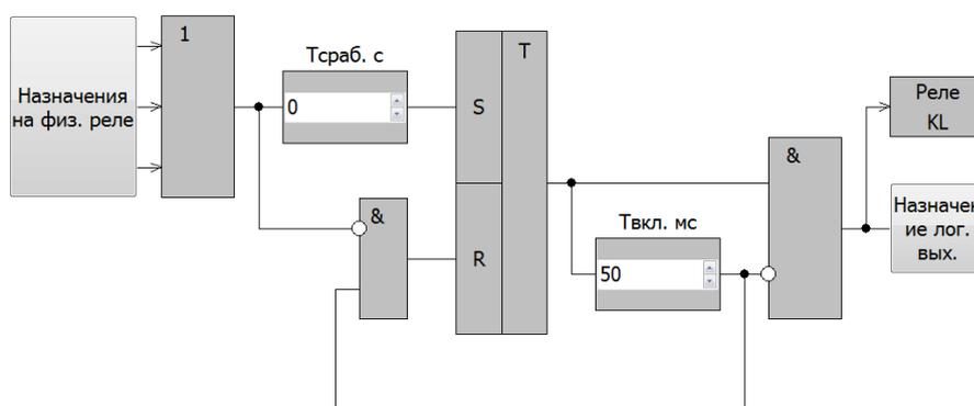
Рисунок 104 – Алгоритм работы реле в импульсном режиме
