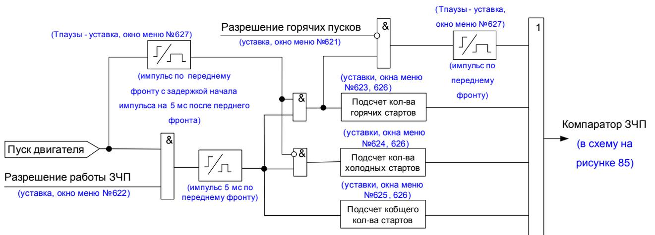
Рисунок 87 – Функциональная схема логики компаратора ЗЧП
