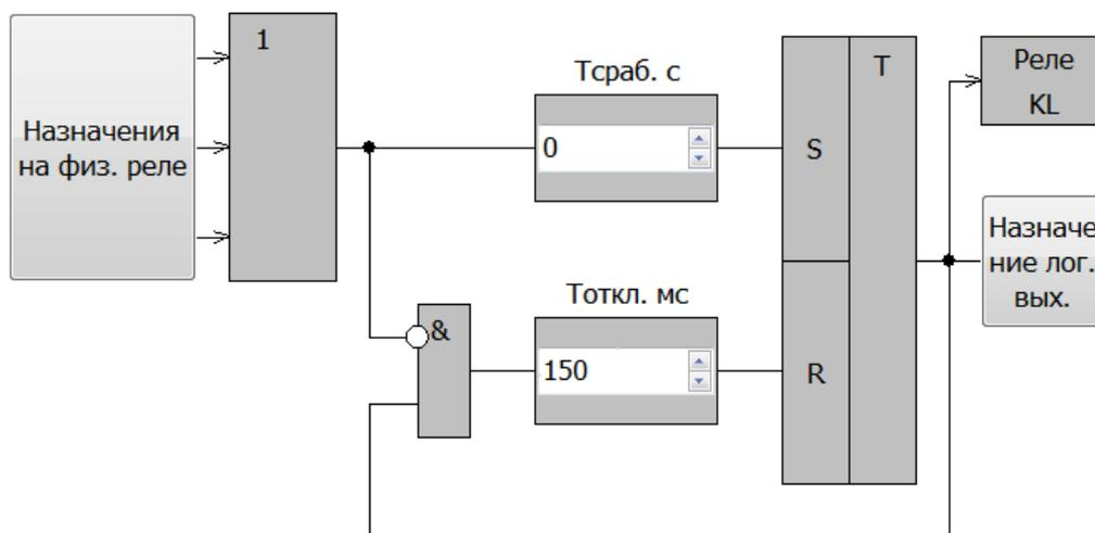
Рисунок 108 – Алгоритм работы реле в потенциальном режиме
