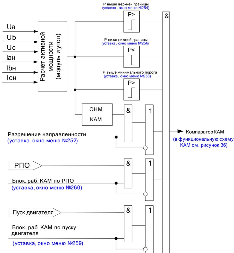
Рисунок 38 – Функциональная схема логики компаратора КАМ
