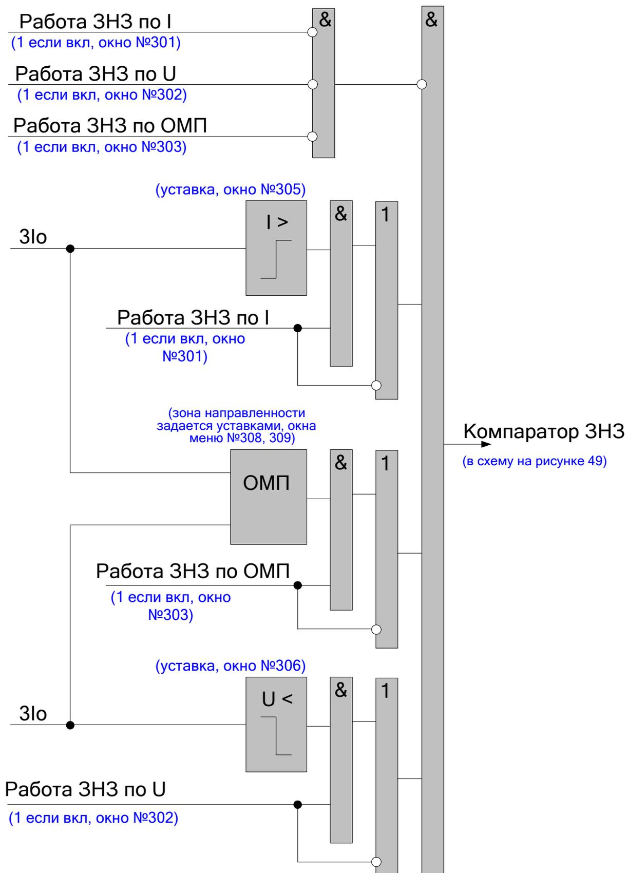
Рисунок 51 – Функциональная схема логики компаратора ЗНЗ
