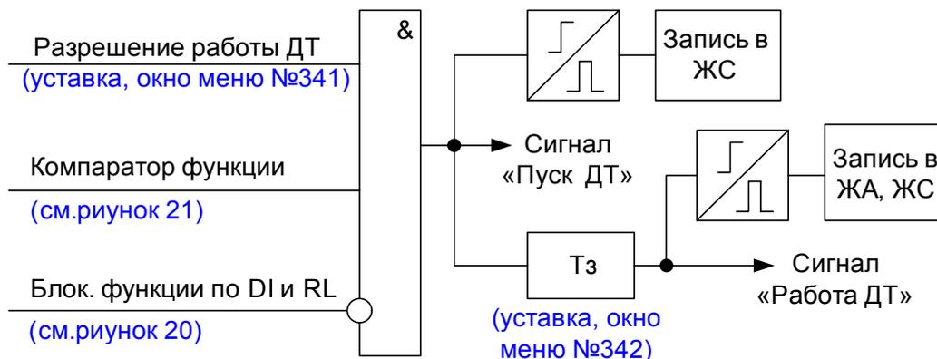
Рисунок 19 – Фрагмент функциональной схемы логики ДТ
