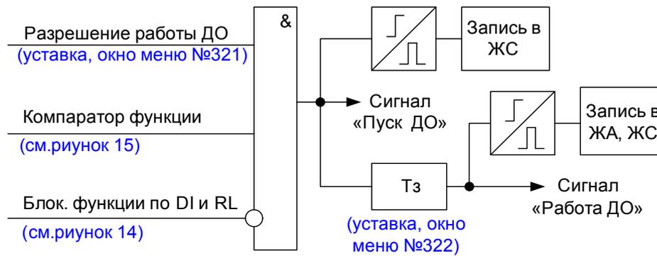
Рисунок 13 – Фрагмент функциональной схемы логики ДО
