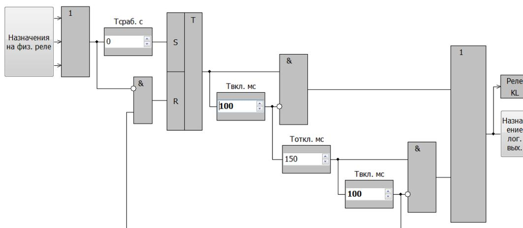
Рисунок 106 – Алгоритм работы реле в импульсном режиме
