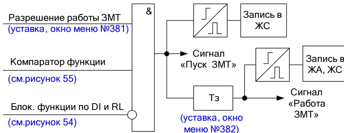
Рисунок 53 – Фрагмент функциональной схемы логики ЗМТ
