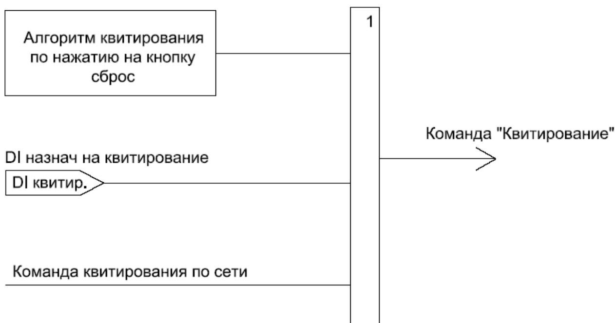
Рисунок 98 – Алгоритм работы функции квитирования
