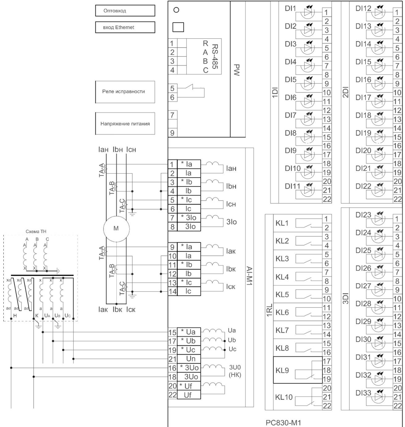
Рисунок Е.3 – Схема подключения устройства PC830-M1 (исполнений XX13XXXXXX)
