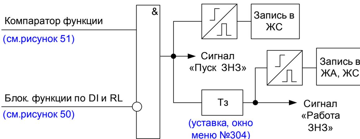
Рисунок 49 – Фрагмент функциональной схемы логики ЗНЗ
