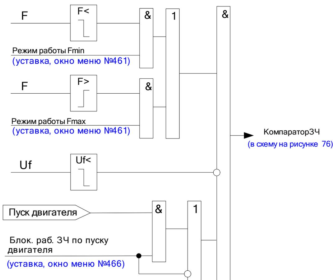
Рисунок 77 – Функциональная схема логики компаратора ЗЧ
