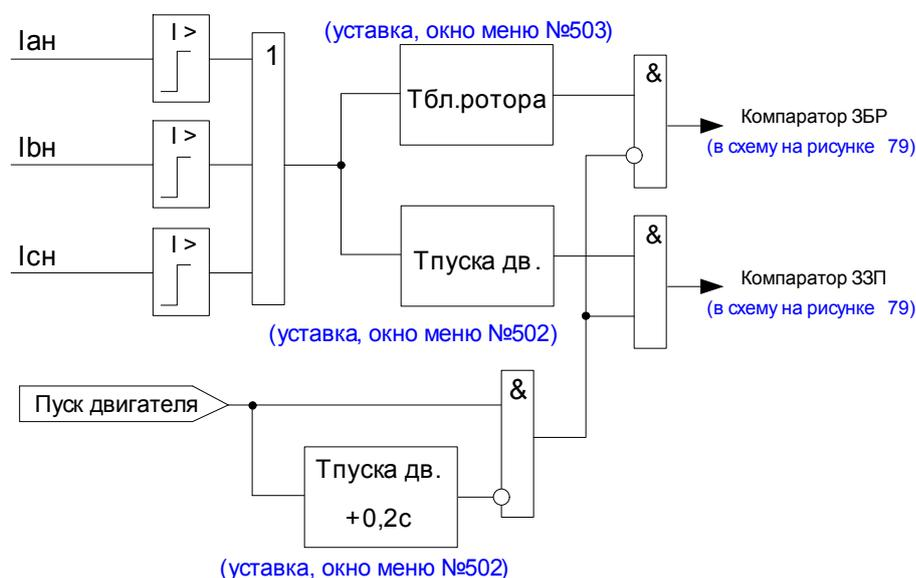
Рисунок 81 – Функциональная схема логики компаратора ЗЗП и ЗБР
