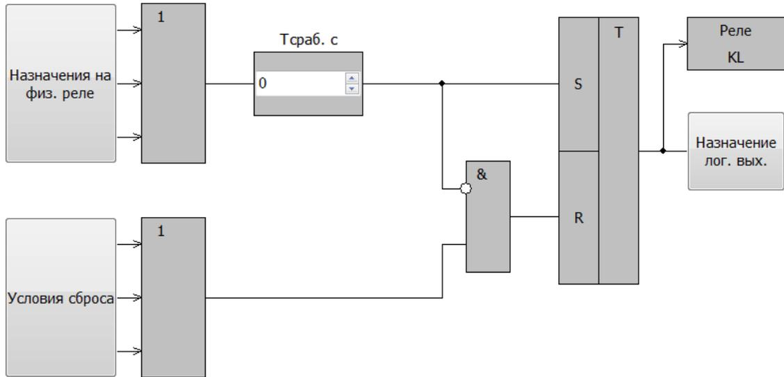
Рисунок 110 – Алгоритм работы реле в режиме с фиксацией
