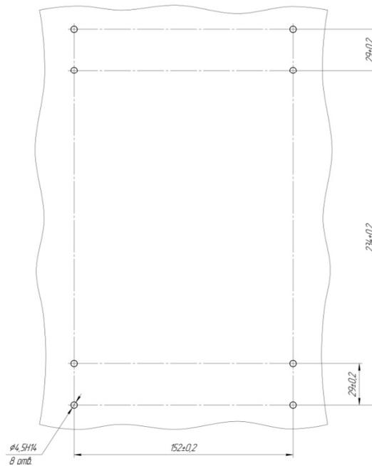
Рисунок Б.3 – Габаритные и присоединительные размеры устройства РС830-М1 при внешнем монтаже, обеспечивающем его поворот влево/вправо
