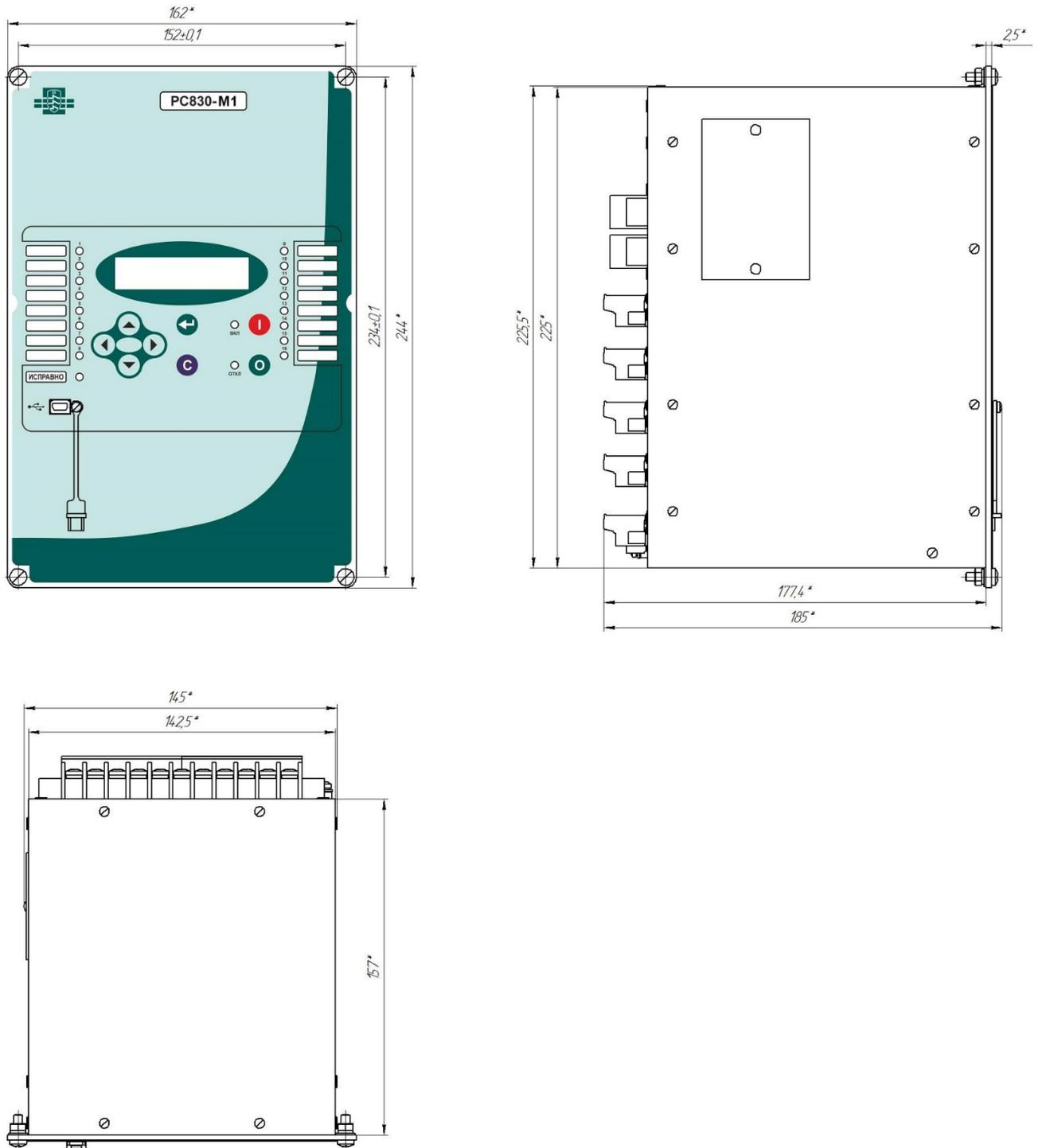
Рисунок Б.1 – Габаритные и присоединительные размеры устройства PC830-M1
