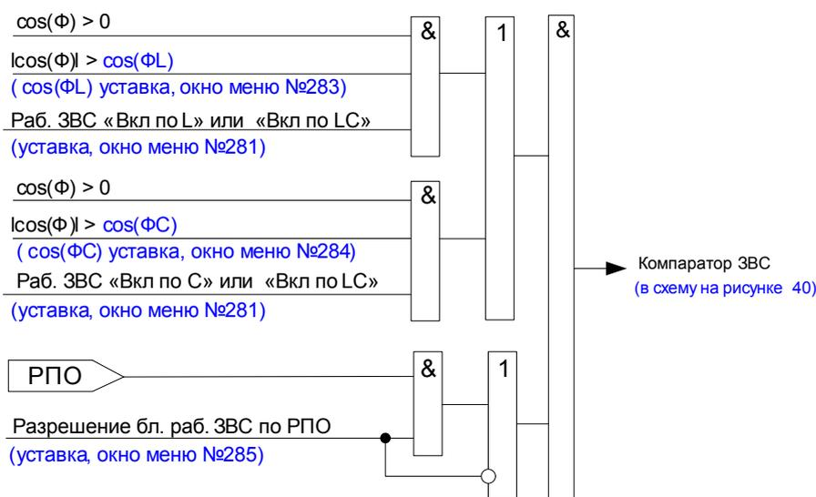
Рисунок 42 – Функциональная схема логики компаратора ЗВС
