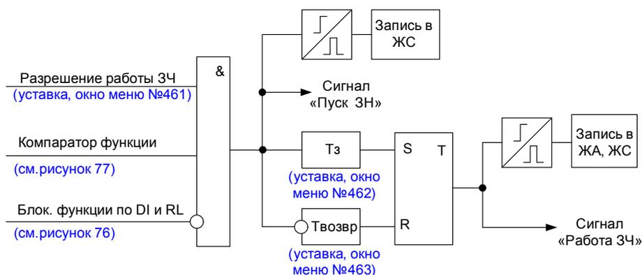
Рисунок 75 – Фрагмент функциональной схемы логики ЗЧ
