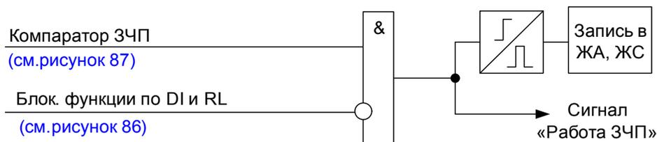
Рисунок 85 – Фрагмент функциональной схемы логики ЗЧП
