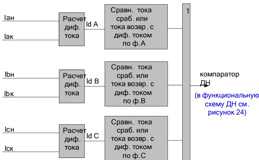
Рисунок 26 – Функциональная схема логики компаратора ДН
