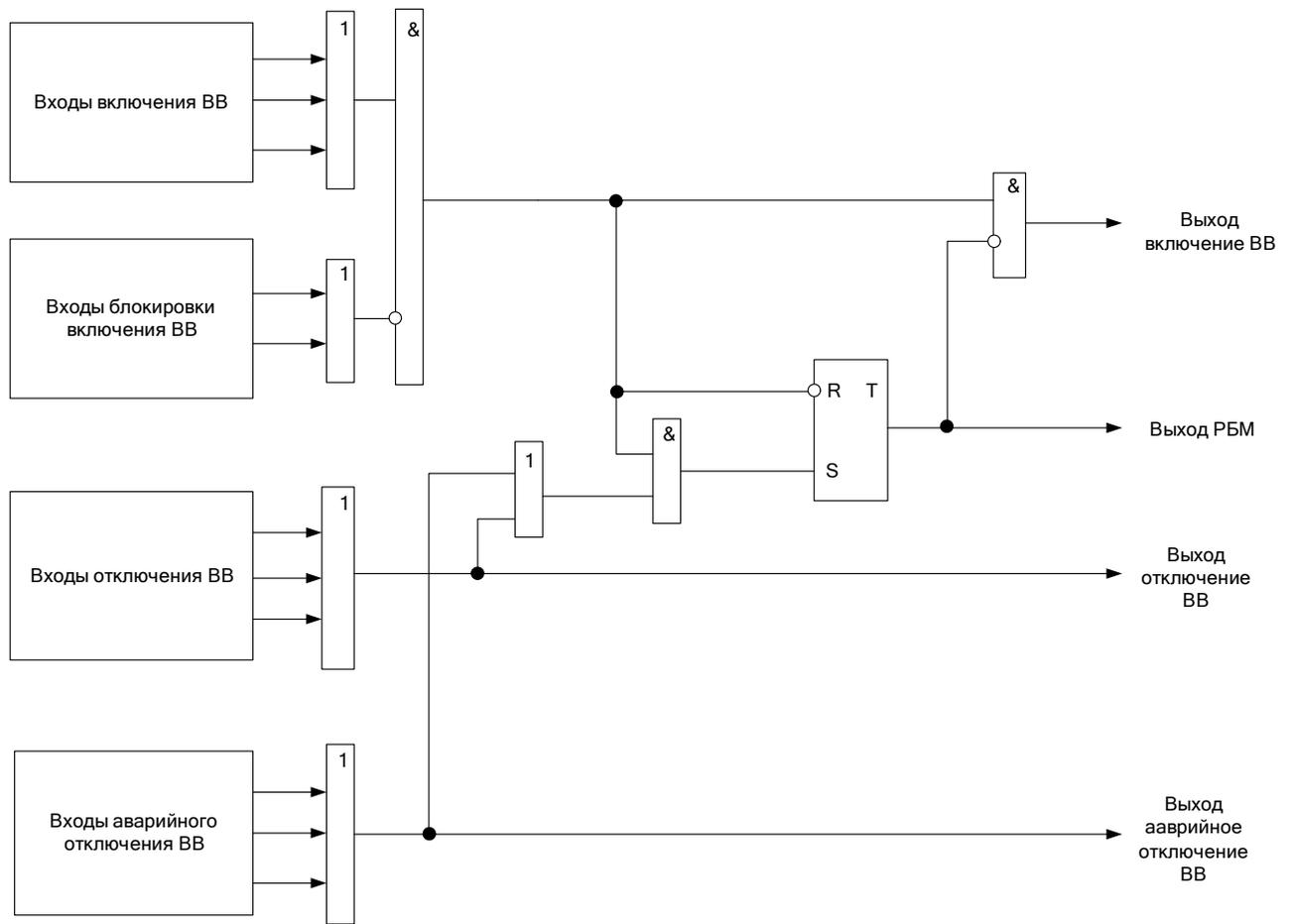
Рисунок 99 – Блок схема алгоритма работы АУВ
