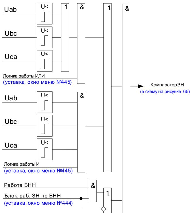
Рисунок 70 – Функциональная схема логики компаратора 3Н при работе в режиме 3ПН по линейным напряжениям
