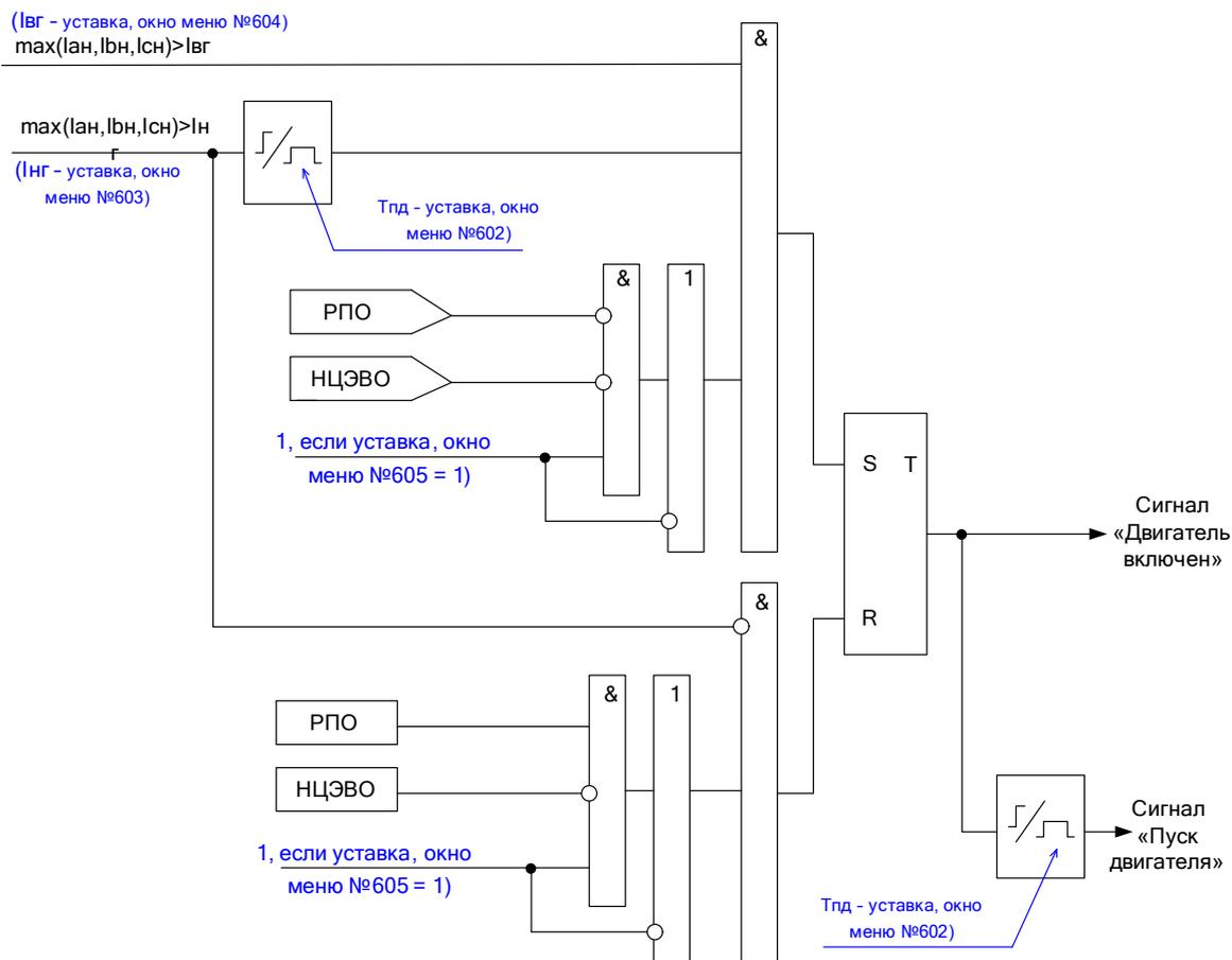
Рисунок 83 – Фрагмент функциональной схемы алгоритма ИПД
