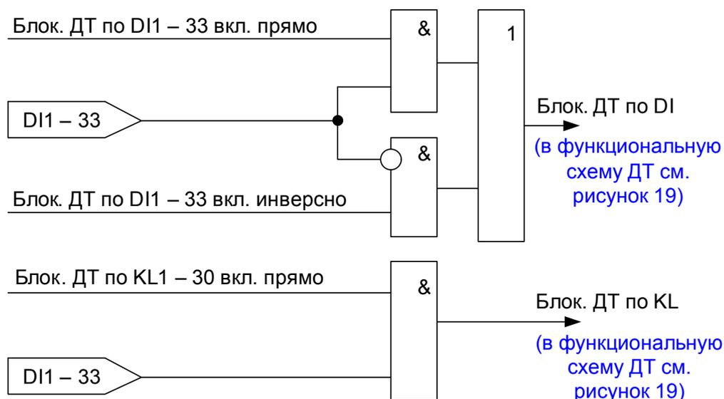
Рисунок 20 – Алгоритм формирования сигналов блокировки (ускорения) ДТ по дискретным входам и логическим выходам реле
