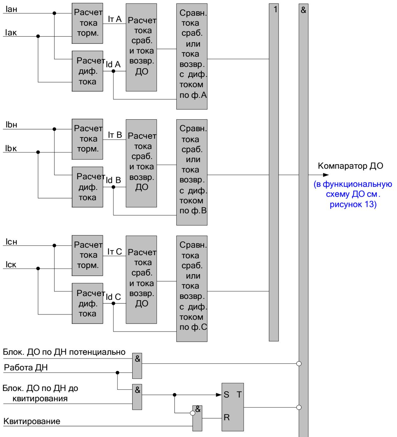
Рисунок 15 – Функциональная схема логики компаратора ДО
