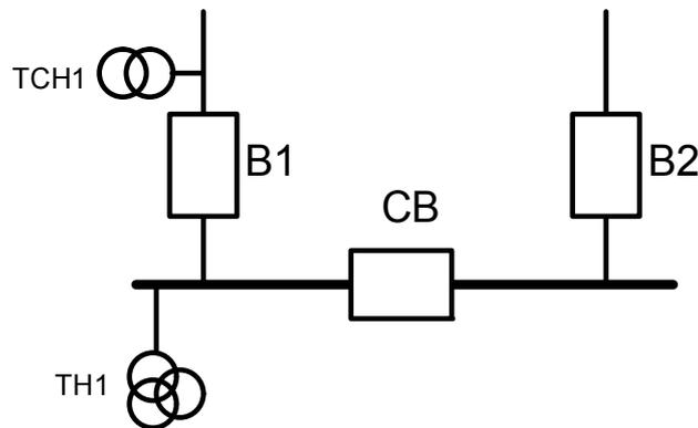
Рисунок 102 – Выявление неисправности цепей напряжения с использованием информации от второго трансформатора (ТСН или ТН)
