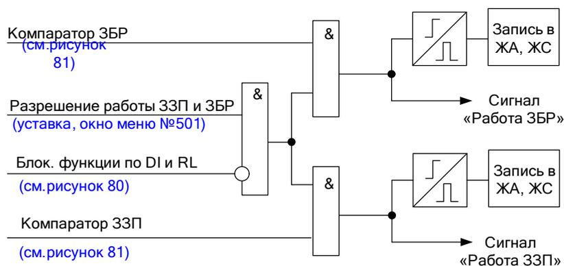
Рисунок 79 – Фрагмент функциональной схемы логики ЗЗП и ЗБР
