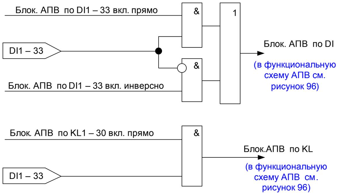
Рисунок 95 – Алгоритм формирования сигналов блокировки АПВ по дискретным входам и логическим выходам реле
