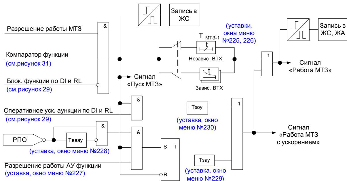
Рисунок 28 – Фрагмент функциональной схемы логики МТЗ
