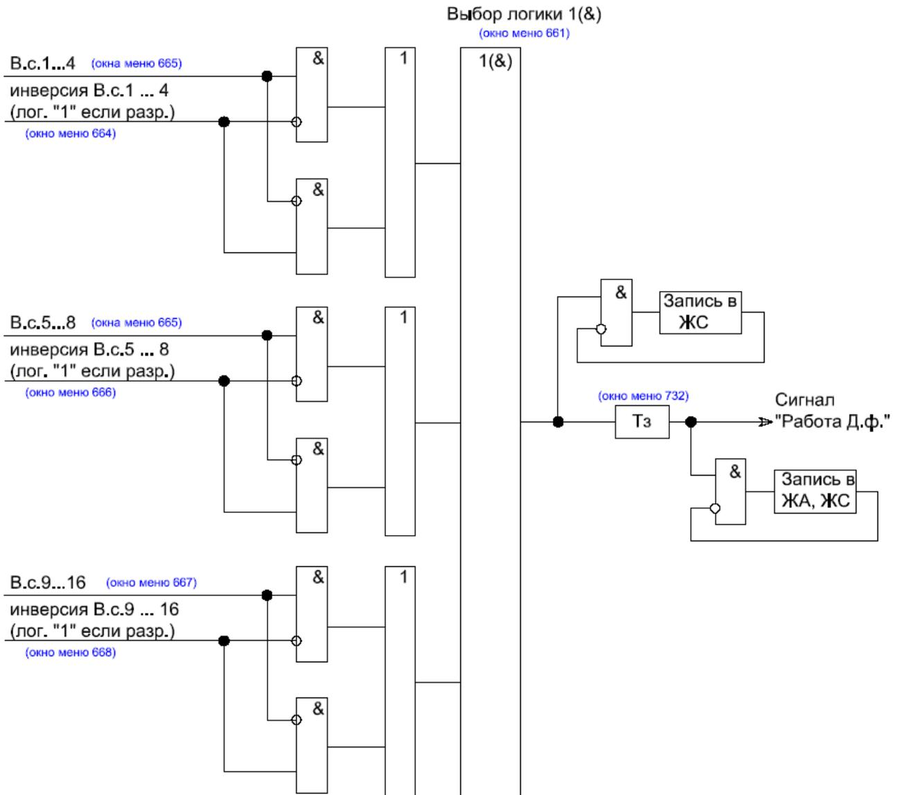
Рисунок 47 – Фрагмент функциональной схемы логики Дф
