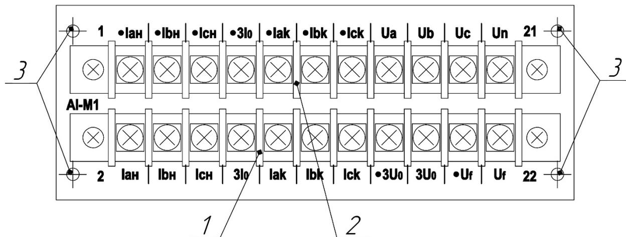
Рисунок 11 – Модуль AI-M1 (вид со стороны разъемов для внешних подключений) и его маркировка
