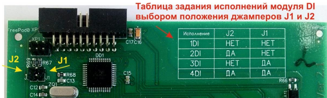
Рисунок 7 – Таблица задания исполнений модуля DI и места установки джамперов J1 и J2
